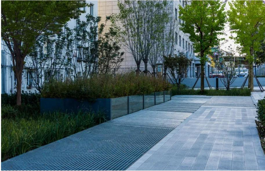
景观用地考虑海绵城市设计方法，在有限的绿化面积里，下凹绿地占总绿地面积的40%以上。采用下渗、滞留、净化的策略，缓解社区内的洪涝灾害。
